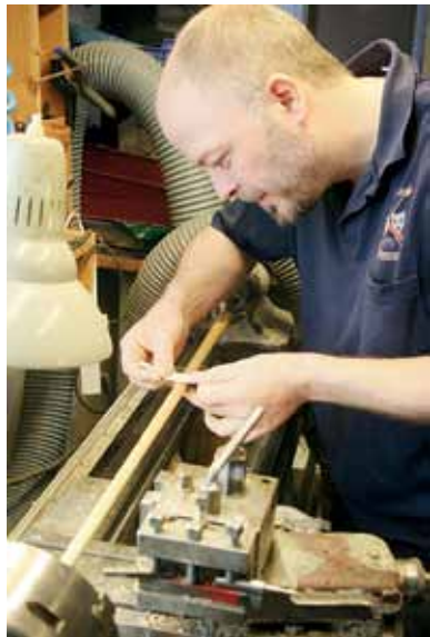
Ett minutiöst noggrant arbete vid svarven krävs när en ny biljardkö ska tillverkas.
