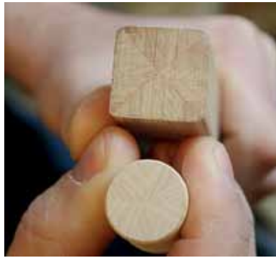
Råämnet till kön består av en käpp som är sammanfogad av mellan 25–40 bitar.
